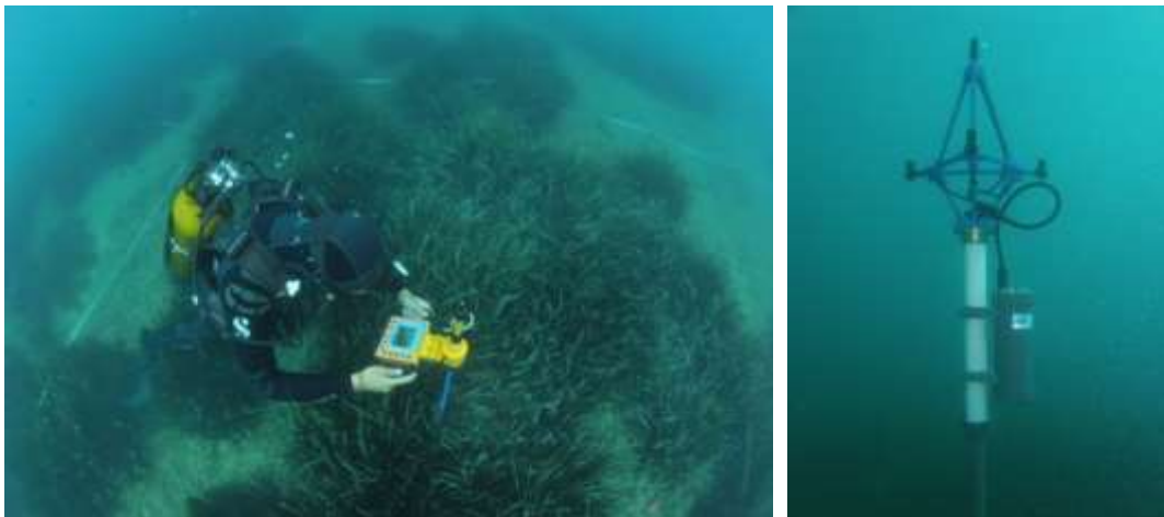
Figure 5: Plongeur opérant avec le pointeur de l'Aquamètre D100 à gauche et base de l'Aquamètre D100 à droite.
